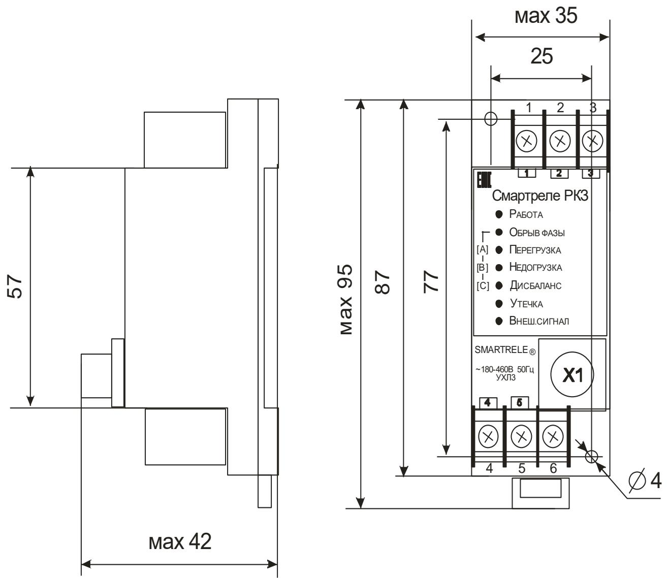
Рисунок 2 – габаритные и установочные размеры электронного блока реле
