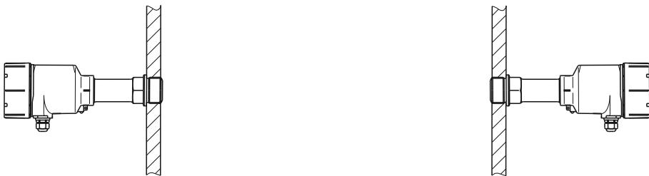
При установке в стенку емкости, кабельный ввод должен быть направлен вниз.
