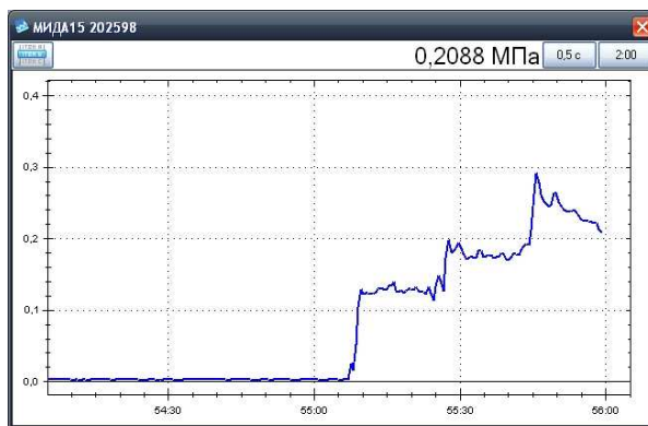
Рисунок К.3 – Окно мониторинга давления
