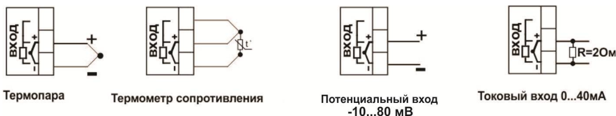
Рисунок 8 – Схема подключения датчиков температуры
