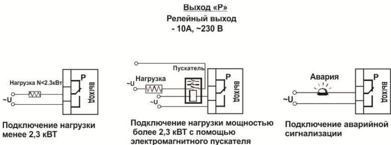
Рисунок 9 – Схемы подключения релейных выходов.
