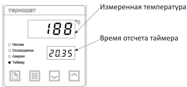
Рисунок 6 – Описание индикаторов при настройке таймера Термодат-10К7-А
