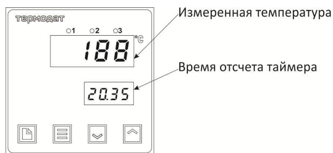
Рисунок 7 – Описание индикаторов при настройке таймера Термодат-10К7-М
