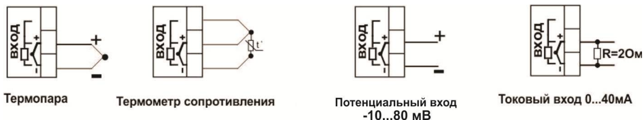
Рисунок 10 – Схема подключения датчиков температуры
