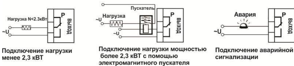
Рисунок 11 – Схемы подключения релейных выходов.
