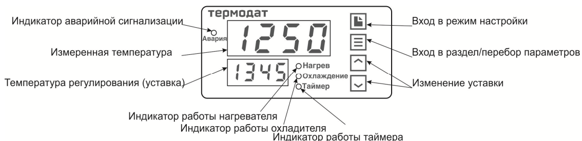
Рисунок 6 – Описание индикаторов и кнопок управления прибора 12К6-D8-Н/... и 12К6-Н...
