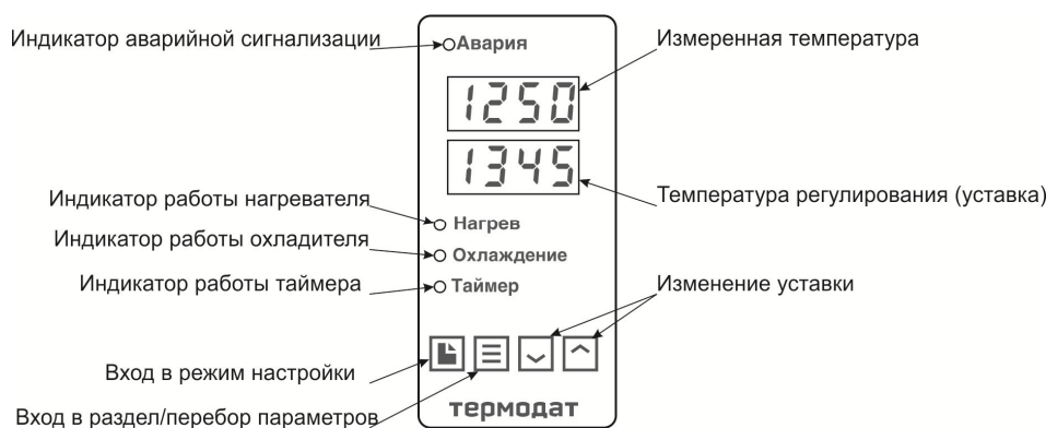
Рисунок 5 – Описание индикаторов и кнопок управления прибора 12К6-D8/... и 12К6-B...
