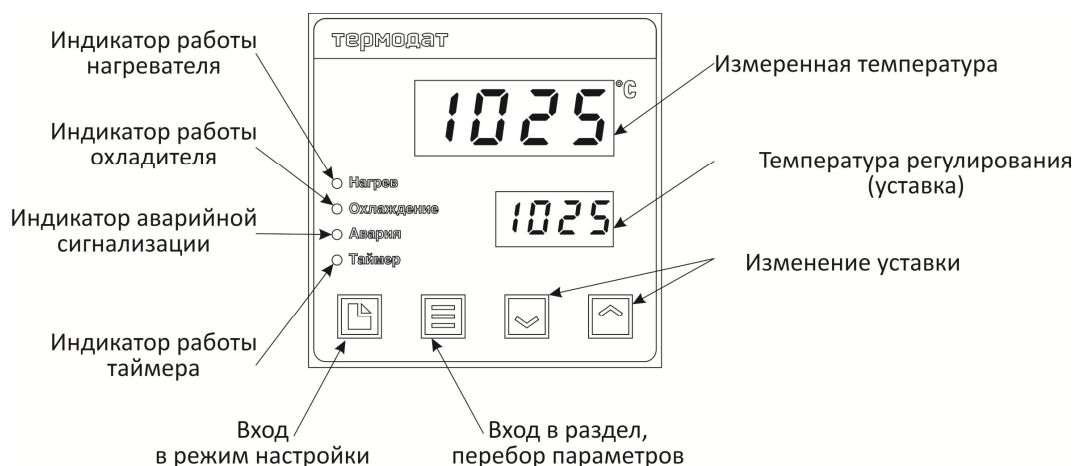
Рисунок 4 – Описание индикаторов и кнопок управления прибора 12К6-D4/... и 12К6-A...
