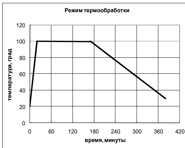
Рисунок 4 –График режима термообработки
