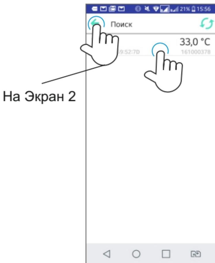
Выберите из списка нужный термометр и кликните на него, после этого вернитесь на Экран 2 (экран подключённых термометров).
