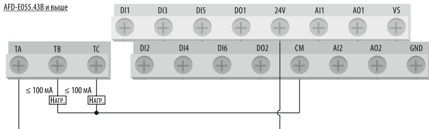
Рисунок 45 – схема подключения нагрузки к релейному выходу (питание от внутреннего источника питания 24 В).
