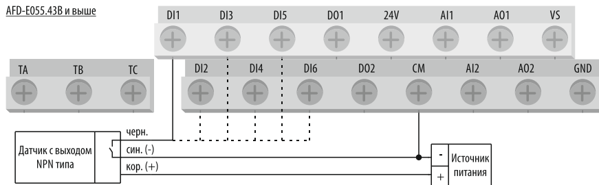
Рисунок 39 – схема подключения датчиков с выходом NPN типа к дискретным входам (питание от внешнего источника питания 24 В).
