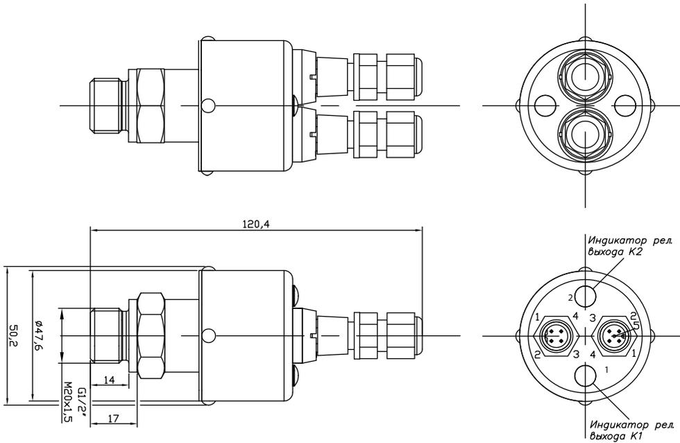
С приварным сенсором корпус датчика длиннее на 8 мм
