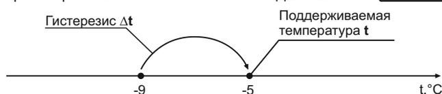
При этом охладительный элемент, управляемый терморегулятором, будет охлаждать морозильную камеру до -9 °С и отключаться. После повышения в ней температуры на 4°С, т.е. до -5 °С, терморегулятор снова включит охладительный элемент, начнется охлаждение и цикл повторится.
