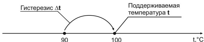
При этом охлаждательный элемент, управляемый терморегулятором, будет охлаждать объект до +90 °С и отключаться. После повышения температуры на 10°С, т.е. до 100 °С, терморегулятор снова включит охлаждательный элемент, начнется охлаждение и цикл повторится.
