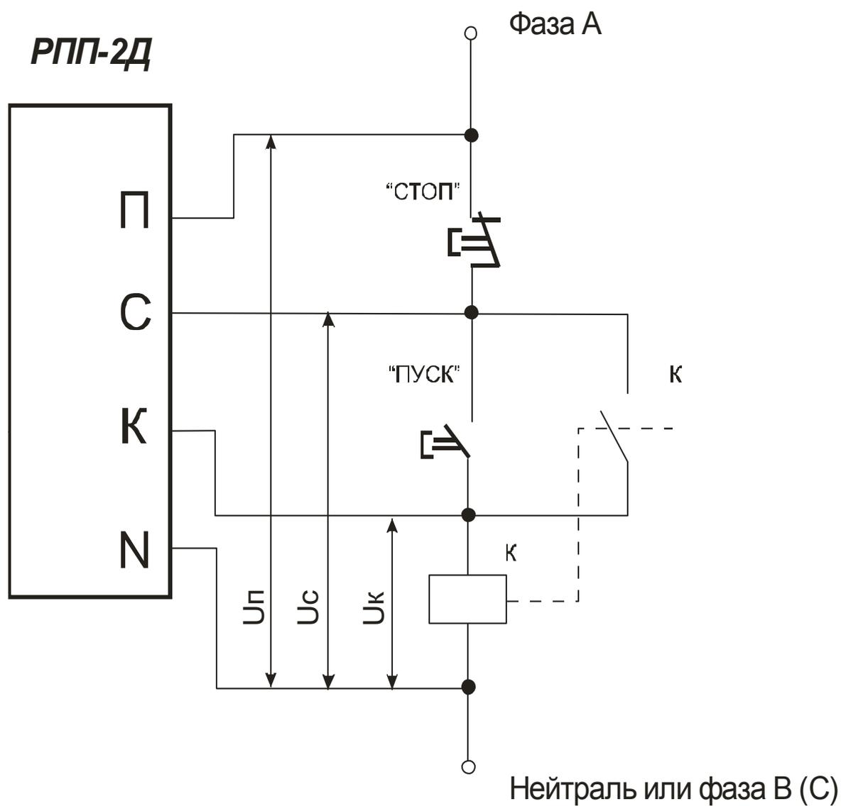
Рисунок 2 – схема подключения реле РПП-2Д к аппарату управления электродвигателем
